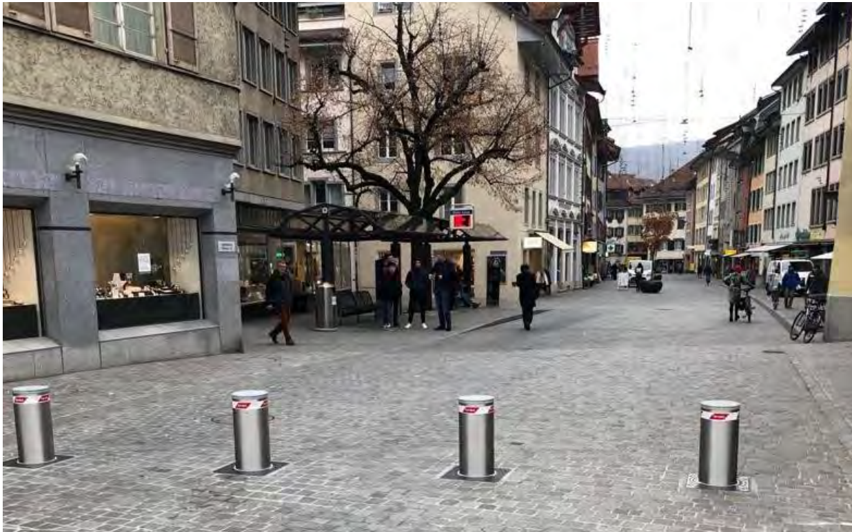
Abb. 14 Versenkbare Poller in Baden
